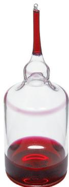
Le secret d'Accuvac : le vide créé dans la cuve en verre hermétique contenant une quantité mesurée de réactif. Le test est réalisé en immergeant l'extrémité du dispositif Accuvac dans l'échantillon, puis en le cassant en appuyant modérément dessus. Le vide aspire l'échantillon dans la cuve, tout en garantissant un mélange homogène. La couleur du résultat est mesurée visuellement ou à l'aide d'un photomètre.
