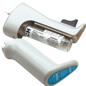
Le Swiftest est un distributeur de poudre qui libère la bonne quantité de DPD (N,N-diéthyl-p-phénylène-diamine) sur simple pression d'un bouton. Il contient suffisamment de réactif pour 50 tests du chlore (libre ou total). Alternative pratique et économique, le Swiftest est idéal pour les laboratoires testant de grandes quantités d'échantillons et pour les analyses sur le terrain.
