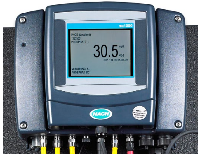
Abbildung 4. Beispiel für vom Phosphax gelieferte Echtzeit-Daten
