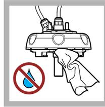
**11.** Stellen Sie sicher, dass sich kein Wasser auf dem Prozesskopf (oder dem automatischen Reinigungsmodul) befindet. Trocknen Sie alle möglichen verschütteten Flüssigkeiten, um das Eindringen von Wasser in den Küvetten-schacht zu verhindern.
