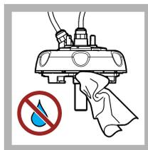
**12.** Stellen Sie sicher, dass sich kein Wasser auf dem Prozesskopf (oder dem automatischen Reinigungsmodul) befindet. Trocknen Sie alle möglichen verschütteten Flüssigkeiten, um das Eindringen von Wasser in den Küvettenfach zu verhindern.
