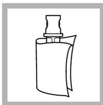
**6.** Reinigen und trocknen Sie die Verifizierungsstandardküvette mit einem fusselfreien Tuch. Siehe [Verschmutzung der Probenküvette verhindern](#) auf Seite 36.
