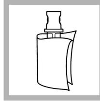
**7.** Reinigen und trocknen Sie die Küvette mit einem fusselfreien Tuch. Siehe [Verschmutzung der Probenküvette verhindern](#) auf Seite 36.
