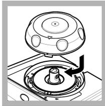
6. Setzen Sie den Kalibrierdeckel wieder auf. Stellen Sie sicher, dass sich der Kalibrierdeckel in geschlossener Position befindet.
