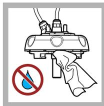
16. Stellen Sie sicher, dass sich kein Wasser auf dem Prozesskopf (oder dem automatischen Reinigungsmodul) befindet. Trocknen Sie alle möglichen verschütteten Flüssigkeiten, um das Eindringen von Wasser in den Küvetten-schacht zu verhindern.
