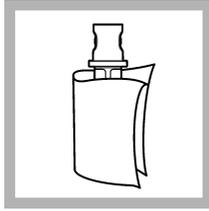
2. Reinigen und trocknen Sie die Küvette mit einem fusselfreien Tuch. Siehe [Verschmutzung der Probenküvette verhindern](#) auf Seite 36.
