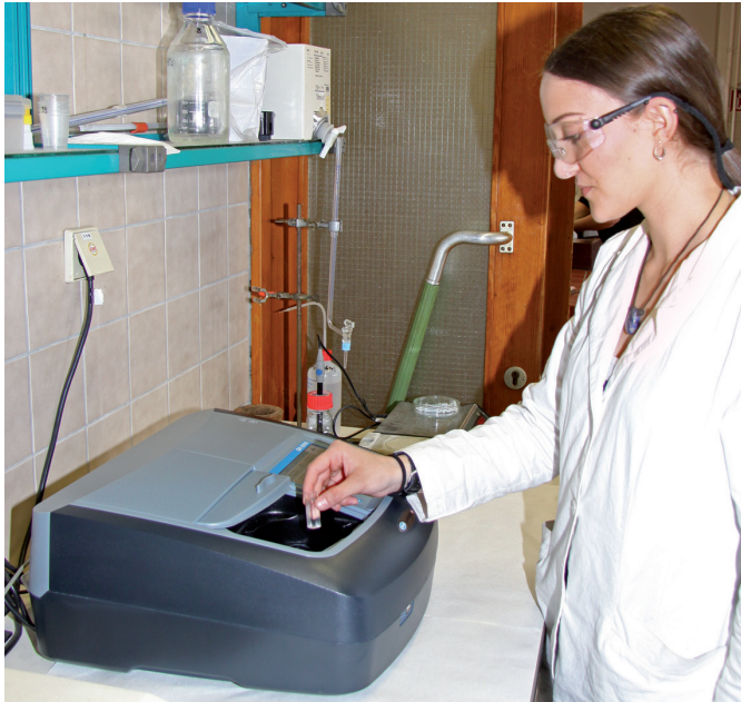
Abbildung 3: Probeneinbringung per Küvette
