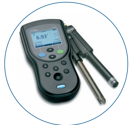
Abb. 10: Der LDO Sensor ist auch in einer tragbaren Variante für den Feld- und Laboreinsatz erhältlich.
