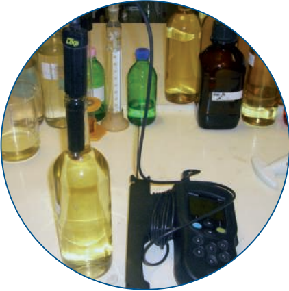
Abb. 3 und 4: Sauerstoff-Messung mit HQD und LDO-Sensor direkt in der Flasche
