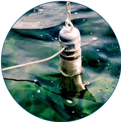
Abb. 5: Sauerstoff-Sensor LDO im Einsatz
