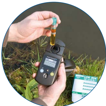
Fig. 7 : des mesures en extérieur d'une simple pression sur un bouton grâce à l'appareil de mesure monoparamètre POCET Colorimètre II, idéal pour les novices.
