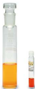
Fig. 4 : les tests en cuve requièrent 90% de produits chimiques en moins comparativement aux procédés par titrage.
