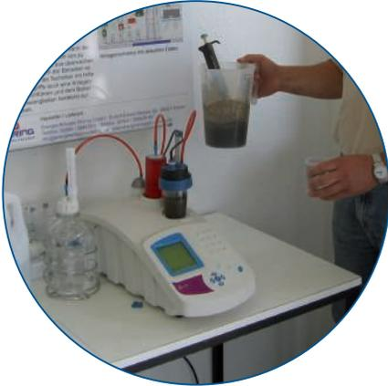
Abb. 1: Der Titrator TIM 840 zur FOS/TAC-Bestimmung auf der Biogasanlage Wambeln
