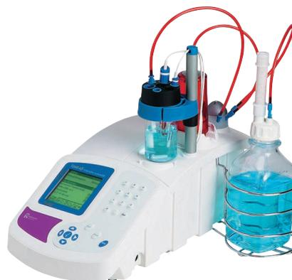
Abb. 4: Der HACH LANGE Titratör TIM 840 für die Bestimmung von FOS/TAC, pH-Wert und Redoxpotential
